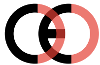
Virheellinen CE-merkki (liian lähellä)
